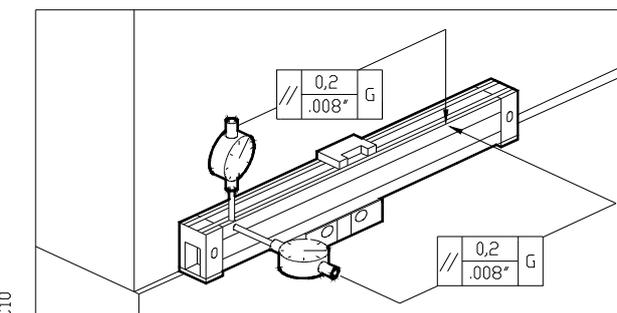
Alinear las caras del transductor, realizando mediciones en los extremos y en el punto central.
