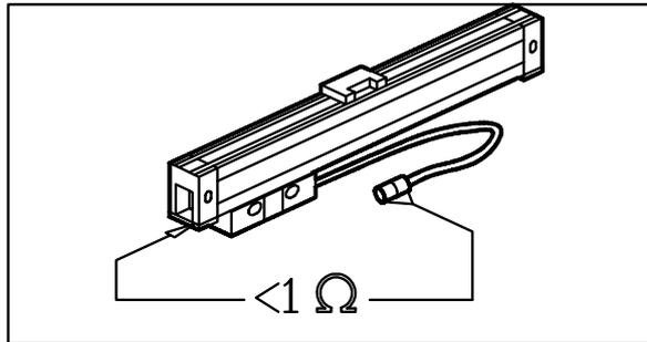
Conectar el cable de la cabeza lectora y comprobar que la impedancia existente entre el conector y el transductor es inferior a 1 Ohmio.
