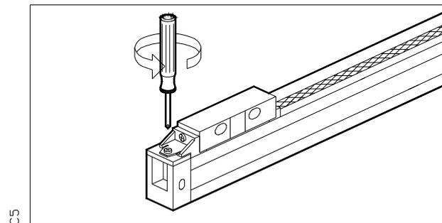
Soltar el tornillo de fijación que se utiliza para el transporte del transductor.
