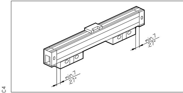
Llevar la máquina a tope mecánico y situar el transductor teniendo en cuenta el curso útil de la misma y el mínimo radio "R" de curvatura que permite el cable.
